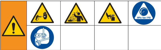
Questa apparecchiatura rimane pressurizzata finché la pressione non viene scaricata manualmente. Per evitare gravi lesioni causate dal fluido pressurizzato, ad esempio da iniezioni nella pelle, schizzi di fluido e parti mobili, seguire la Procedura di scarico della pressione quando si smette di erogare e prima di pulire, controllare o eseguire la manutenzione dell'apparecchiatura.
