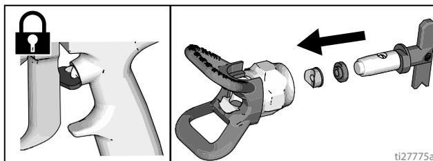
2. Inserire SwitchTip nel foro dell'ugello e avvitare bene sulla pistola.
