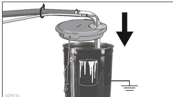
20. Azionare nuovamente tutte le pistole in un secchio di lavaggio finché non compare la vernice. Montare gli ugelli e le protezioni.
