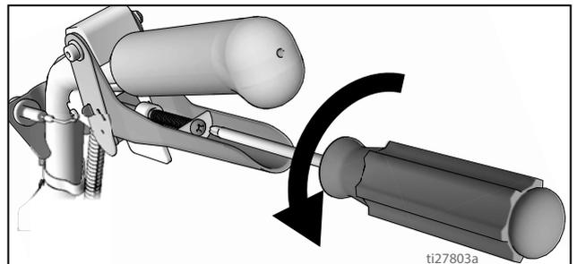
4. Continuare la regolazione della vite fino a che l'icona di spruzzatura e la spruzzatura del fluido non risultano sincronizzati. Potrebbe essere necessario regolare i cavi delle pistole.
