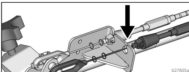
3. Inserire il blocco del cavo di plastica nel foro della staffa del cavo.
