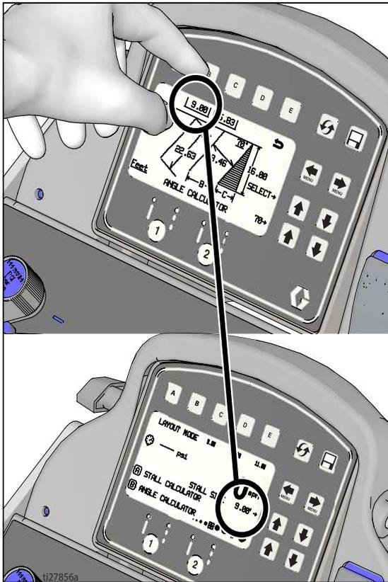
5. Premere e rilasciare il comando del grilletto della pistola per iniziare a tracciare i punti delle dimensioni dello stallo. Premere e rilasciare il comando del grilletto della pistola per smettere di tracciare.
