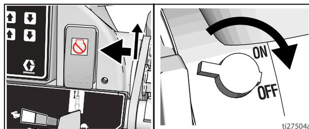
3. Portare il controllo della pressione all'impostazione più bassa. Premere il grilletto di tutte le pistole per scaricare la pressione.
