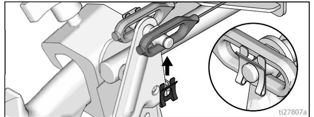
5. Far passare il cavo attorno all'unità e sopra di essa attraverso i fori dietro il supporto del flessibile.
