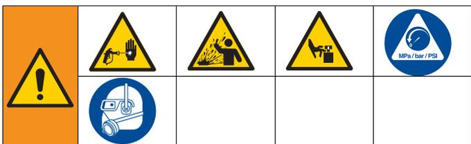
Questa apparecchiatura rimane pressurizzata finché la pressione non viene scaricata manualmente. Per evitare gravi lesioni causate dal fluido pressurizzato, ad esempio da iniezioni nella pelle, schizzi di fluido e parti in movimento, seguire la Procedura di scarico della pressione quando si smette di erogare e prima di pulire, controllare o eseguire la manutenzione dell'apparecchiatura.
