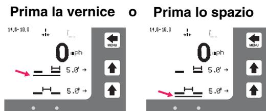
In modalità automatica, le pistole non funzionano o si spengono se la velocità è inferiore al valore impostato.
