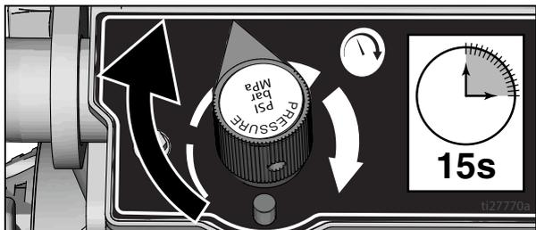
16. Abbassare la pressione, mettere in posizione orizzontale le valvole di ricircolo. Disinserire la sicura del grilletto della pistola.
