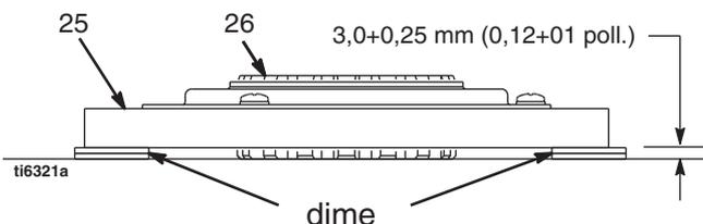
4. Installare l'armatura (25) sull'albero di trasmissione del motore.
