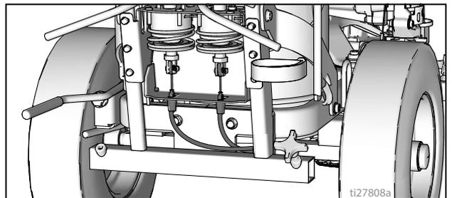
6. Far passare l'anello terminale del cavo attraverso il foro rettangolare della staffa e inserire il blocco del cavo in plastica nella staffa dell'attuatore. Installare l'estremità del cavo sull'asta dell'attuatore, quindi inserire il perno.
