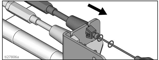
4. Installare l'estremità del cavo sul perno della piastra del grilletto e installare il fermo.
