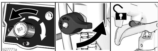
17. Tenere tutte le pistole contro un secchio metallico di lavaggio messo a terra. Azionare le pistole e aumentare lentamente la pressione del fluido finché la pompa non funziona agevolmente.
