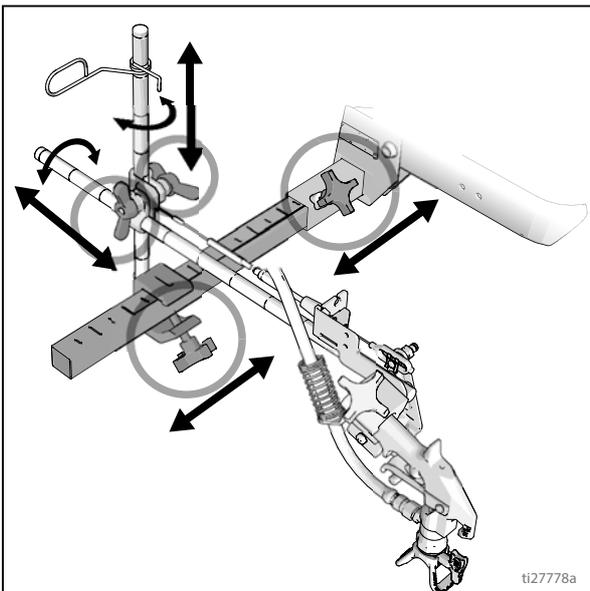
NOTA: Quando si tracciano le linee sopra un cordolo, il morsetto di montaggio può essere ruotato in modo che vi sia spazio.
