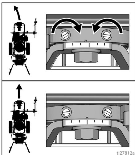
4. Far avanzare il traccialinee. Ripetere i passaggi 2 e 3 fino a che il traccialinee non avanza in modo dritto. Serrare la vite sulla piastra di allineamento della ruota per fissarne la nuova impostazione.
